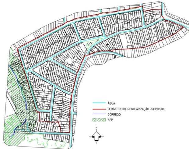
Redesenho da rede de abastecimento de água (segundo SABESP) sobre LEPAC
